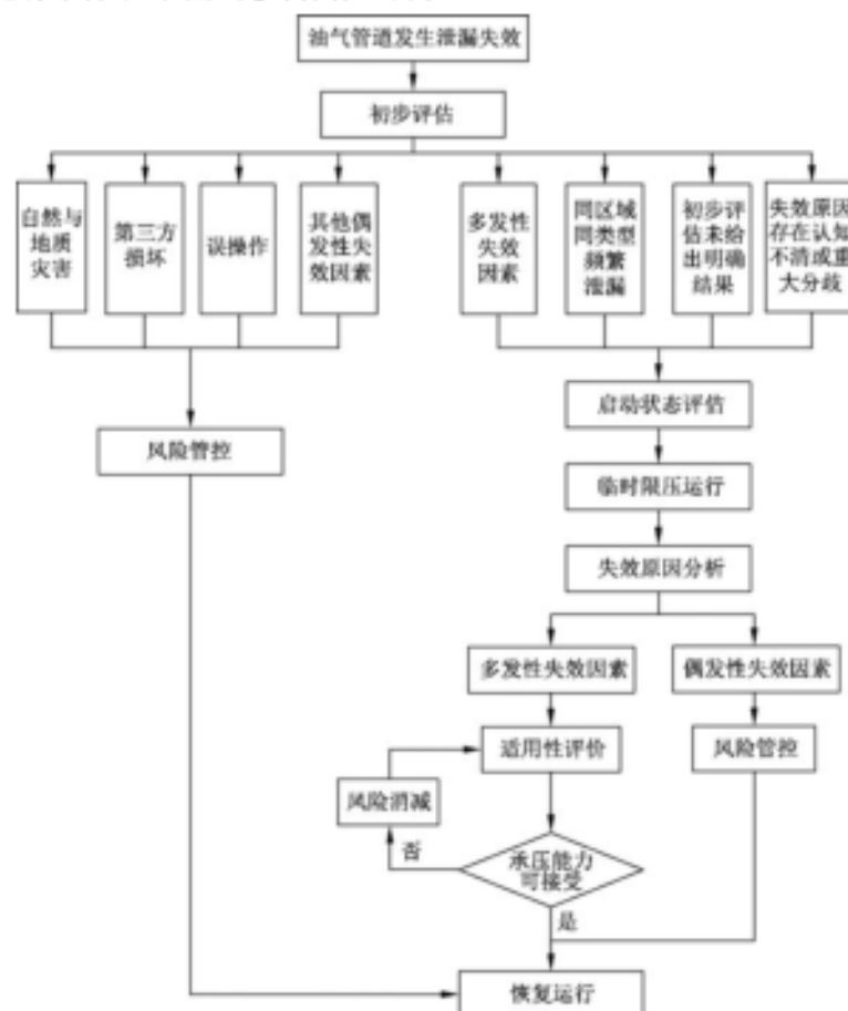
图 1 油气管道恢复运行压力评估流程
