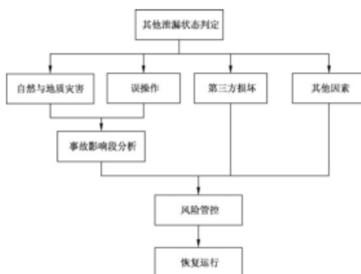
图5 其他泄漏状态判定流程
